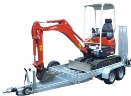
Obrázek 13: Přepravník stavebních strojů Bat B30.36, brzděný, 3000 kg [23]
