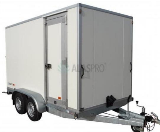
Obrázek 12: Skříňový přívěs AVZ 35 2700 kg, 3500x1700x1970 mm [22]
