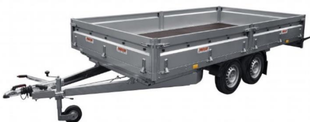
Obrázek 5: Přívěs Neptun Nordica N20-420 2 KPS 2000 kg 4200x2150 mm [12]
