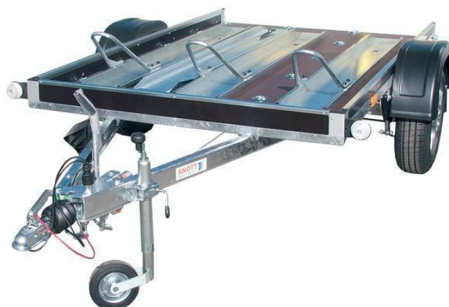
Obrázek 15: Přívěs pro přepravu motocyklů Agados Kangaro 15 B1, 2500 x 1480 mm [26]
