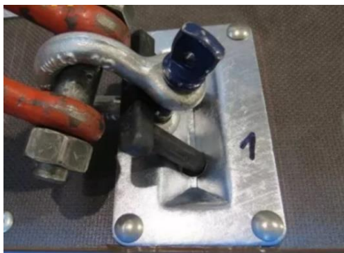
Obrázek 46: Zátěžová zkouška kotevního oka Vezeko [13]
