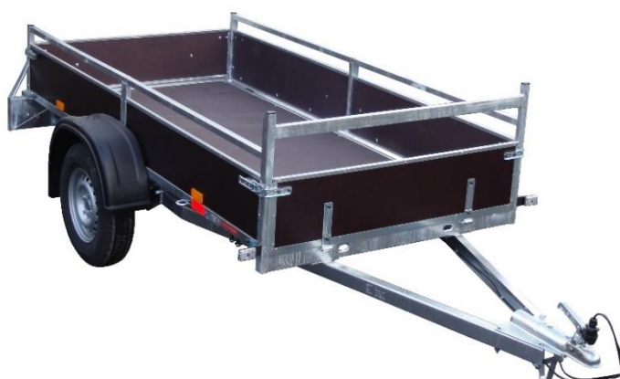
Obrázek 4: Nebrzděný přívěs APV N1 750 kg 2100x1280 mm [11]
