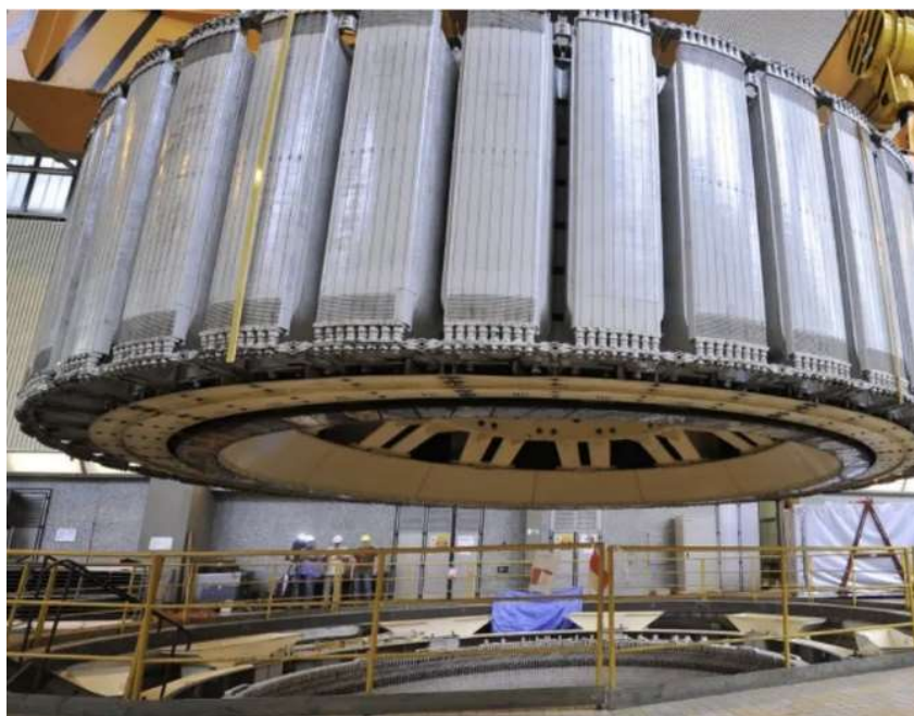
Obrázek 23: Rotor s vyniklými póly v PHES Dalešice, převzato z [32]
