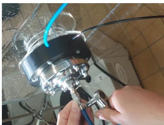
Obrázek 36: Montáž nebulizační hlavy z nerezové oceli[37].
