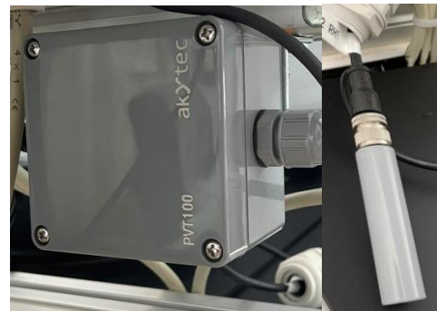
Obrázek 19: Převodník vlhkosti a teploty.
