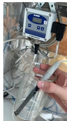
Obrázek 22: Převodník měrné vodivosti.
