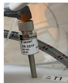
Obrázek 17: Odporový snímač teploty.
