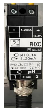
Obrázek 21: Převodník pro pH sondu
