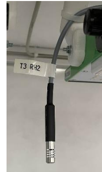
Obrázek 18: Senzor relativní vlhkosti a teploty.
