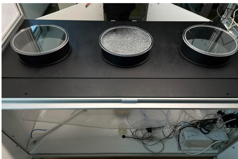
Obrázek 40: Ukázka zavlhčení prostředního otvoru.
