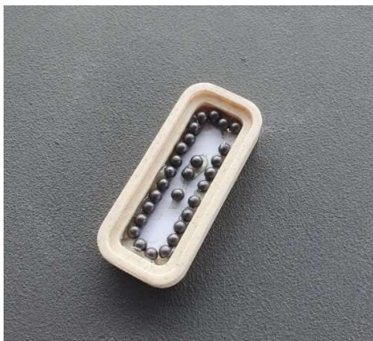
Obr. 32: Tvorba testovacího modelu - zatížení diabolkami, Archiv Autora, 2024
