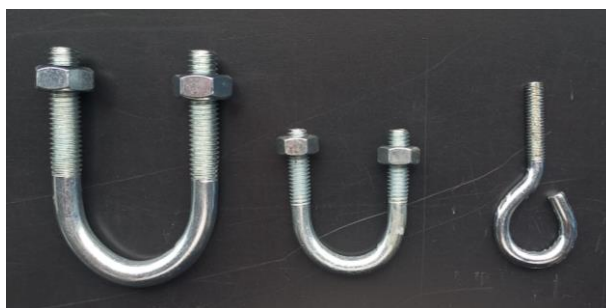
Obr. 28: několik vyzkoušených variant pro uchycení gumy – finální volba vpravo, foto autor 2024
