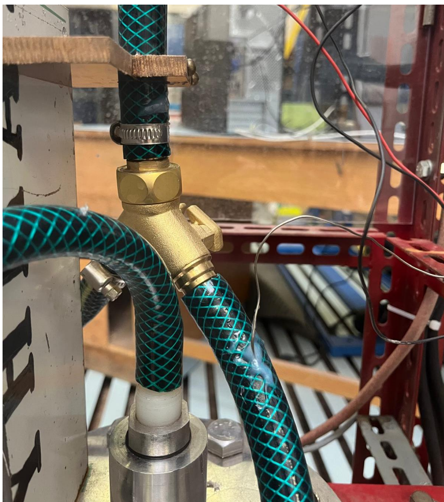
Obrázek 24 – Připojení termočláneku pro měření teploty vody
