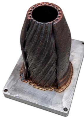
Obr. 19: Část trysky vyrobená metodou wMLD [23]
