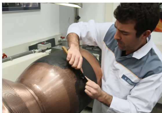
Obr. 18: Nanášení vosku na trysku motoru Vulcain [22]
