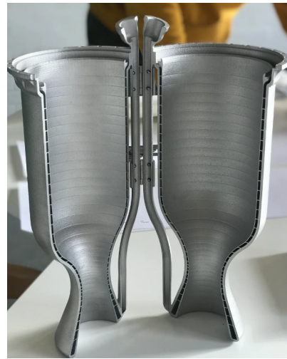
Obr. 16: Řez tryskou týmu DanSTAR [20]
