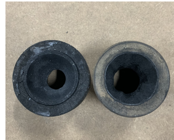
Obr. 11: Použité trysky s ablativní uhlíkovou vložkou
