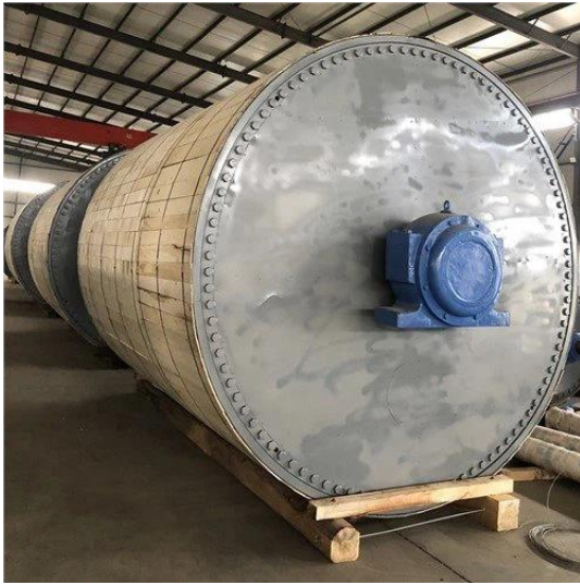
Obr. 31. Litinový sušící válec v ochranném dřevěném krytu
