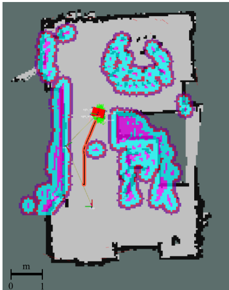
Obr. 58: Naplánovaná trasa před vyhnutím se překážce
