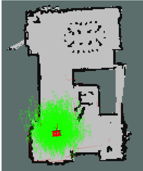
Obr. 55: Odhad polohy na počátku lokalizace s určením výchozí polohy
