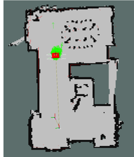
Obr. 56: Odhad polohy z lokalizace s určením výchozí polohy po cca 3 m
