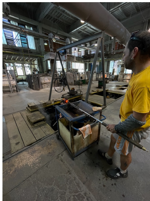
Obr. 42: Nabrání skla na píšťalu
