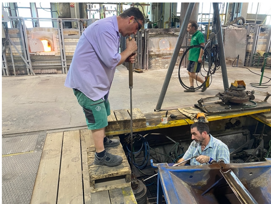
Obr. 43: Foukání skla do formy
