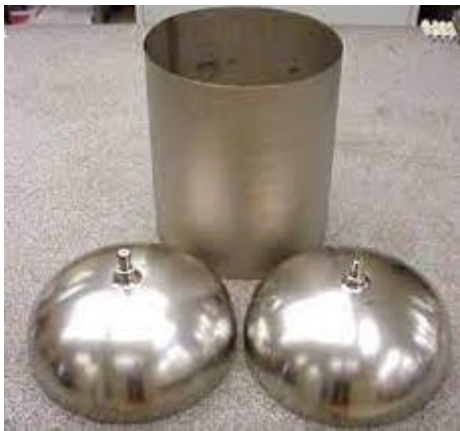
Obr. 5 Liner pro výrobu COPV nádrže [5]
