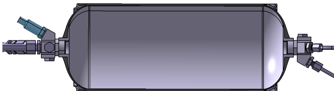
Obr. 28 Detail usazení nádrže v palivové soustavě
