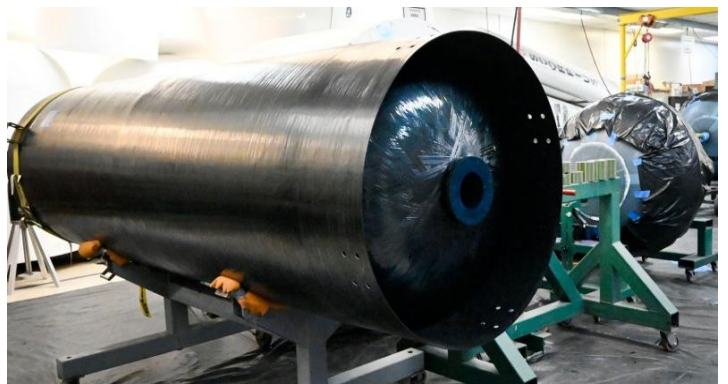
Obr. 6: Segment rakety s integrovanou nádrží [20]
