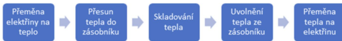
Obrázek 1 Princip fungování Carnotových baterií [1]
