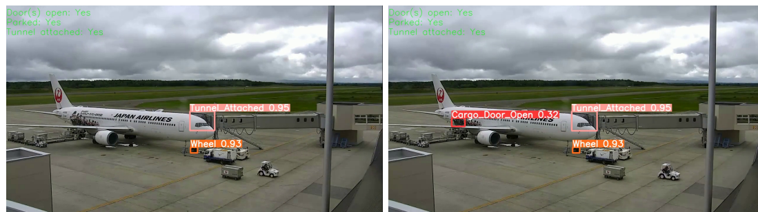
(a) Model nedetekuje zadní dveře kvůli polepu.
