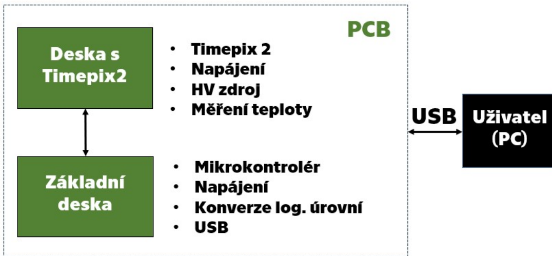
Obrázek 3.1: Koncept řešení vyčítacího rozhraní pro detektor Timepix 2
