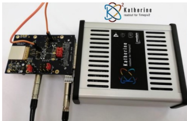
Obrázek 2.4: Vyčítací zařízení Katherine pro Timepix 2 [11]
