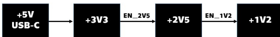
Obrázek 4.4: Napájecí sekvence základní desky
