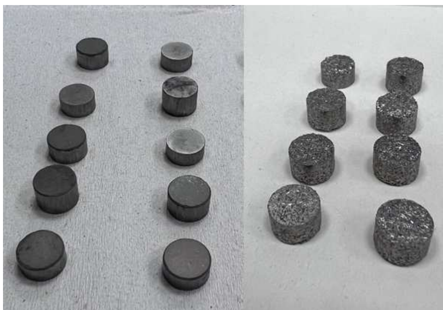
Obrázek 24: Wolframové pelety. Vlevo: hrubost zrna 20 \mu\text{m} . Vpravo: hrubost zrna 0,4 - 0,8 mm
