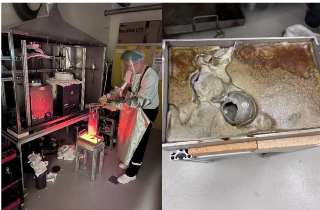
Obrázek 30: Vlevo: Vylévání použité taveniny soli. Vpravo: Zchladlá sůl po vyjmutí z reaktoru technologie MSO
