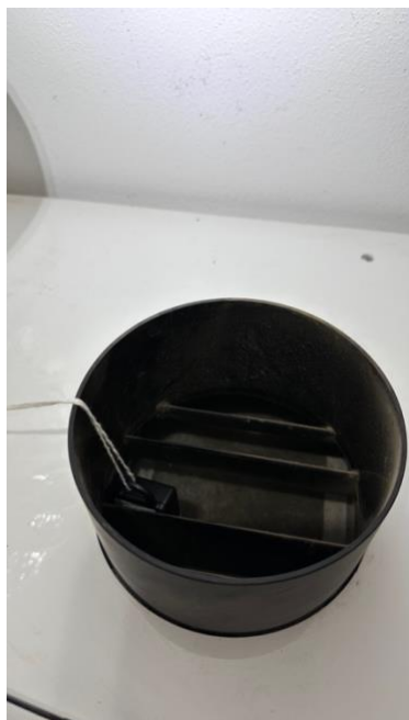
Obrázek 17 Umístění měřicího zařízení na straně sání
