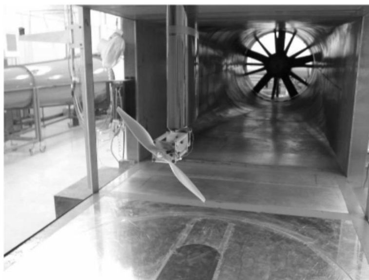
obr. 2: Testovací sekce aerodynamického tunelu UIUC [11]
