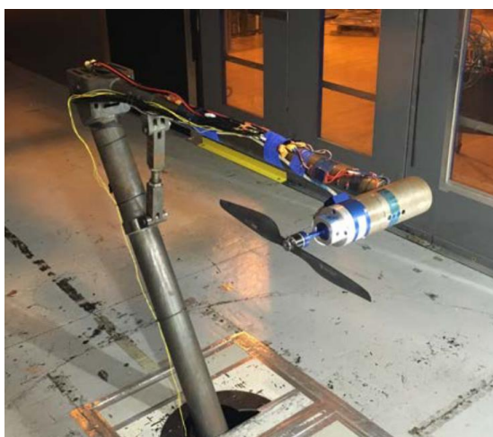
obr. 5 Stojan k uchycení testovaných rotorů [12]
