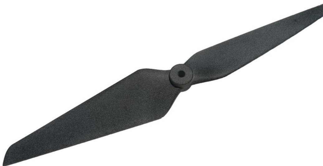
obr. 36: Vytisknutá optimalizovaná geometrie (3. iterace) se zaoblením konce listu
