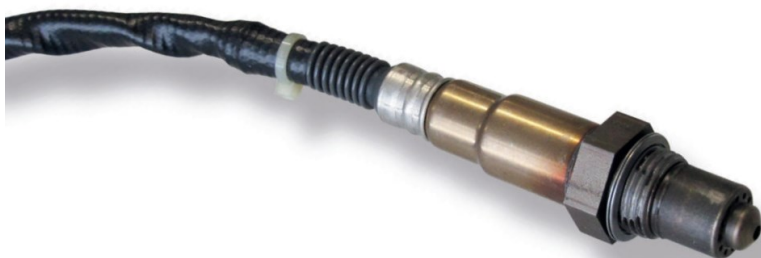
Obr. 24: Bosch širokopásmová lambda sonda LSU 4.9 [18]
