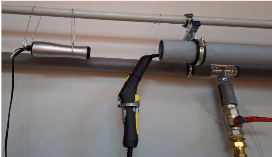
Obr. 45: Ohřívání a vlhčení spalovacího vzduchu
