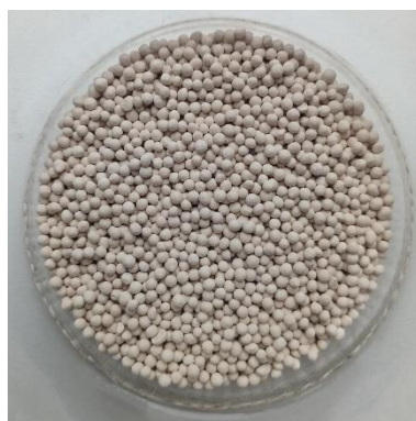
Obrázek 14: Fotografie vzorku molekulového síta 13X
