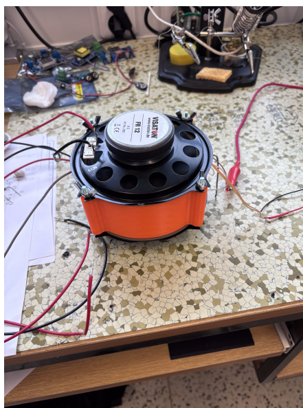
Obrázek 3.4: Mikrofony zavřené v plastové komoře mezi dvěma reproduktory.
