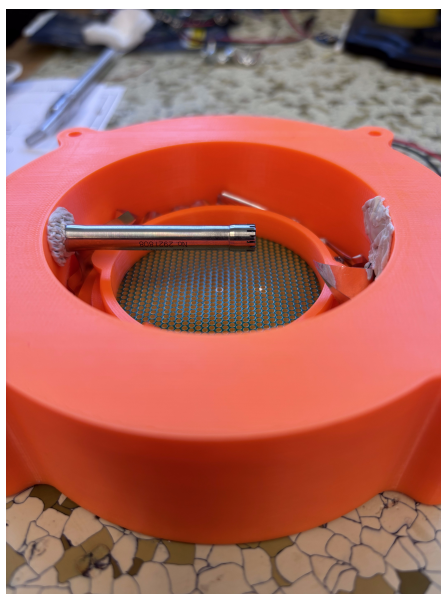
Obrázek 3.3: Vnitřek měřicí komory s měřeným a měřícím mikrofonem.
