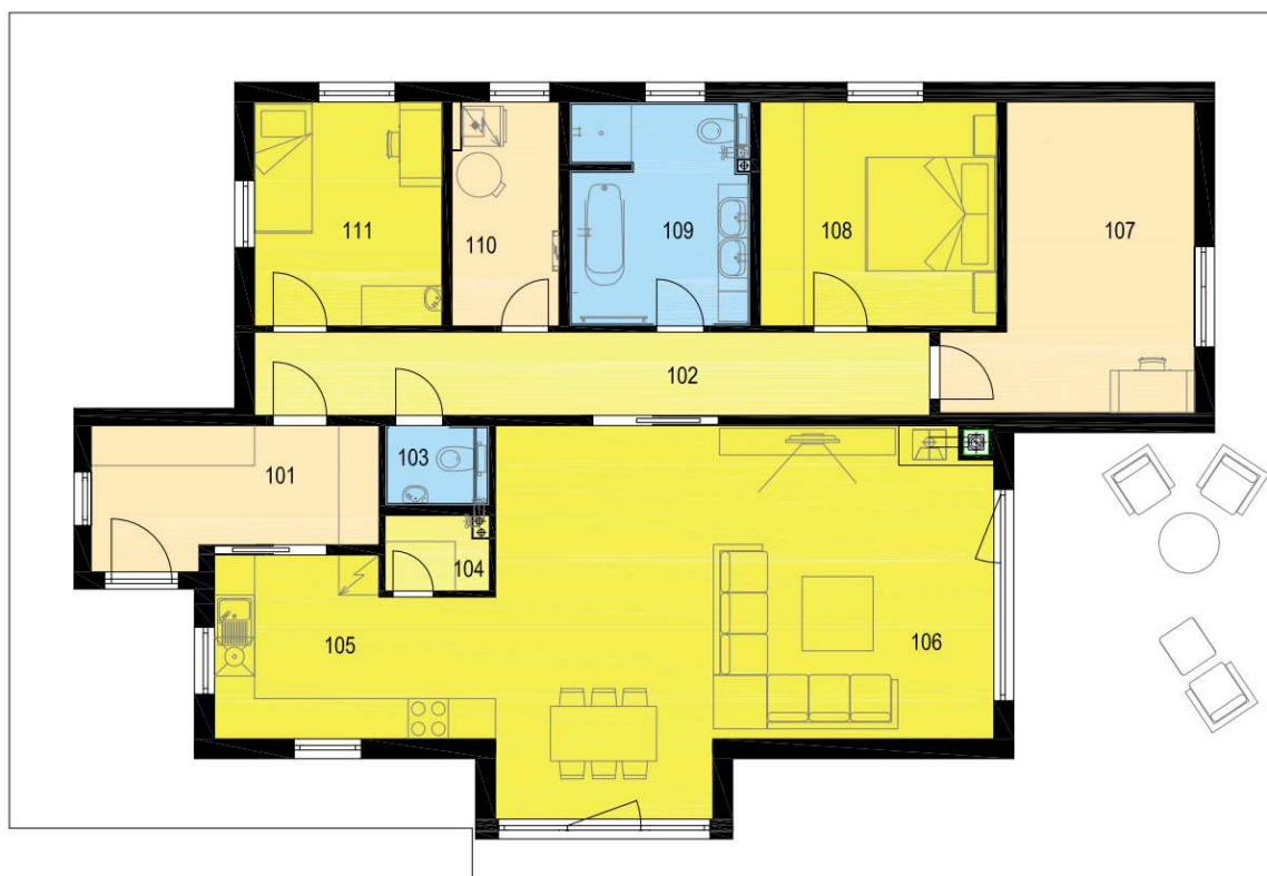
Obr. 32: Schematický půdorys řešeného objektu (jednočarový obrys značí tvar střechy)
