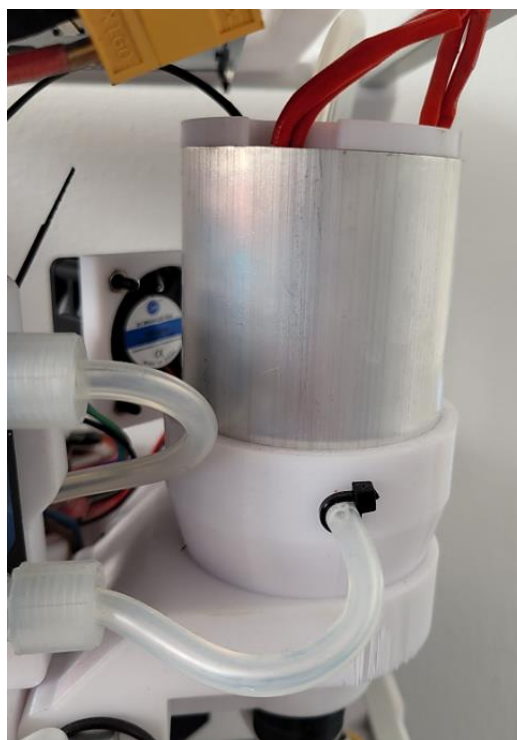
Obrázek 6: Magnetické míchadlo vlastní konstrukce v provedení s permanentními magnety (verze Grade Medical)
