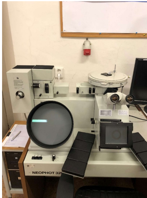
Obrázek 14 Světelný mikroskop Neophot 32
