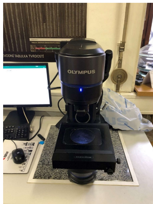
Obrázek 15 Digitální mikroskop Olympus DSX 1000
