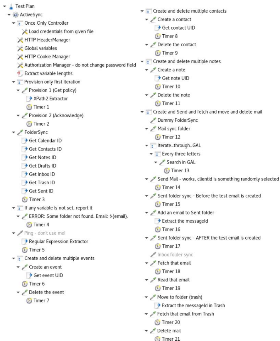
Obrázek 7: Struktura modulu EAS v program JMeter (obsahující optimalizační časovače)
