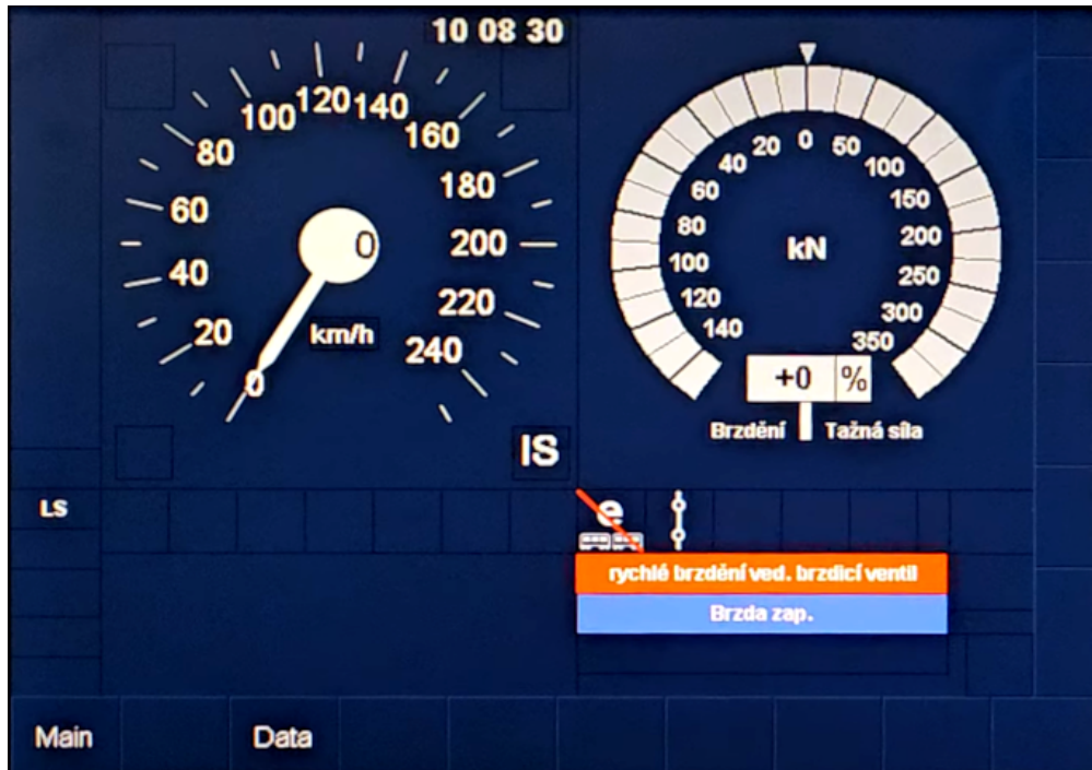
■ Obrázek 2.8 Výchozí obrazovka DMI lokomotivy Vectron z videa z kabiny [13]
