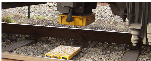
■ Obrázek 2.2 BTM anténa zesponu vlaku projíždějícího přes eurobalízu [7]
