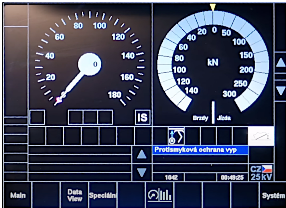
■ Obrázek 2.7 Výchozí obrazovka DMI lokomotivy Traxx MS2 z videa z kabiny [13]
