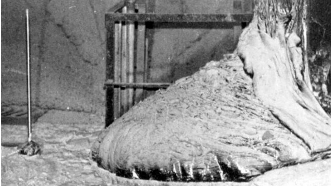
Obr. 2 – "Sloní noha" - Korium vyteklé pod reaktorem č.4, Černobyl. Převzato z [5]
