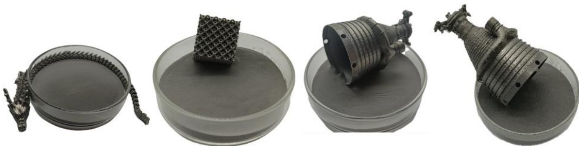
Obrázok 10: Ukážka kovových práškov a výrobkov AM, Z ľava: AlSi10Mg, Ti6Al4V, Incoel 718, CoCrMo [20]
