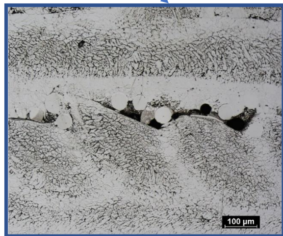
Obr. 28b – detail špatně protavených vrstev
