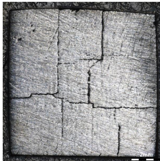
Obr. 22 – vzorek č.17 po zalisování do bakelitu a broušení
