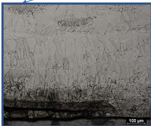
Obr. 29a – zrna protáhlého tvaru kolmo ke podložce
