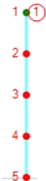
Obr. 395 – Dráha vpichů při měření mikrotvrdoti Obr. 386 – ukázka vpichů u vzorků č. 6 zatížením HV0,5
