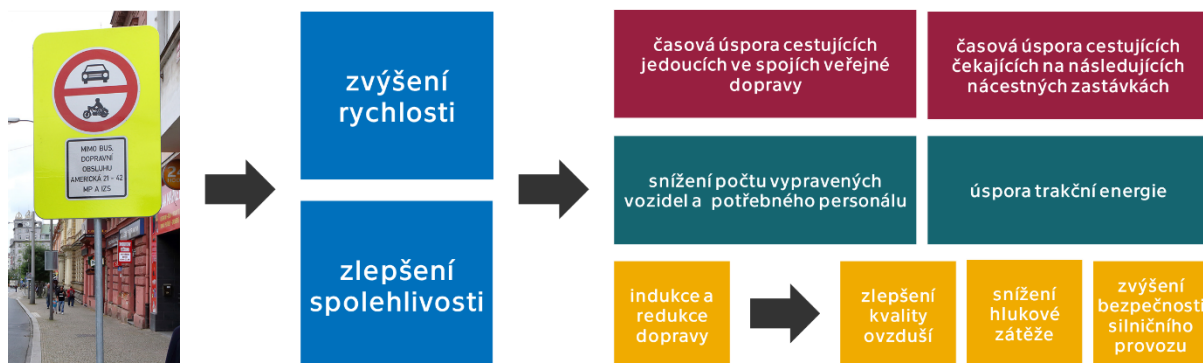
Obr. 23 Přínosy preference veřejné dopravy plynoucí ze zvýšení cestovní rychlosti a zlepšení spolehlivosti provozu
