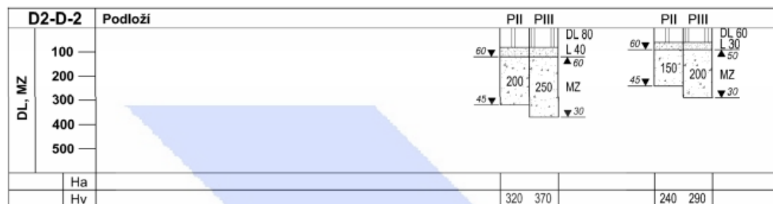
Obrázek 56: Vzorová skladba stezky s dlážděným povrchem [4]
