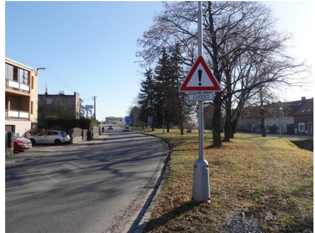
Obrázek 204 – Chybná kombinace SDZ pro upozornění na zvýšený pohyb chodců
