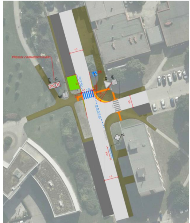
Obrázek 81 – Schematický návrh situace doporučených sanačních opatření v Lokalitě 2 (Varianta 2 – oboustranné zúžení)
