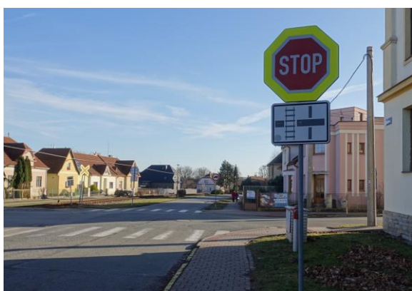
Obrázek 124 – Nevhodná kombinace SDZ s různými světelně-technickými vlastnostmi na severním vedlejším ramenu
