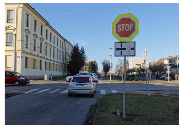
Obrázek 125 – Nevhodná kombinace SDZ s různými světelně-technickými vlastnostmi na jižním vedlejším ramenu
