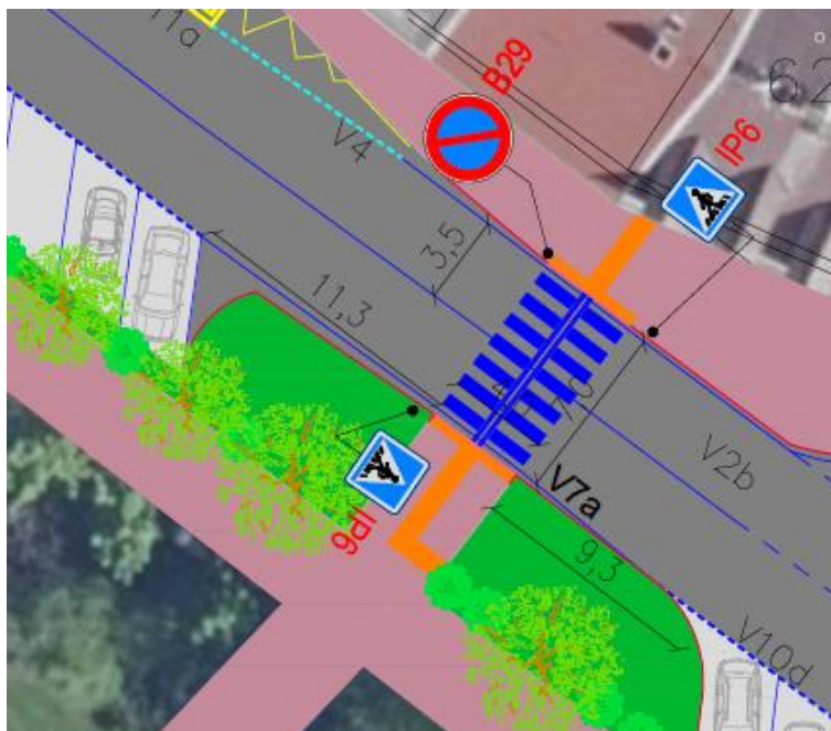
Obrázek 52 - Upravený druhý přechod pro chodce v ulici U Císařských lázní (zdroj: Příloha č. 6.3)
