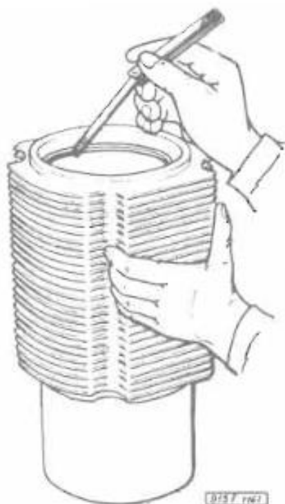
Obr. 15 - Válec motoru Tatra 815 v modifikaci T3B-930-30 při opracovávání výměně pístních kroužků [30]
