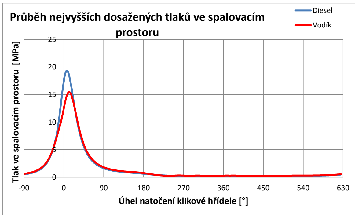
Obr. 24 – Graf - Průběh nejvyšších dosažených tlaků ve spalovacím prostor – nafta při 1600 ot/min, vodík při 1200 ot/min
