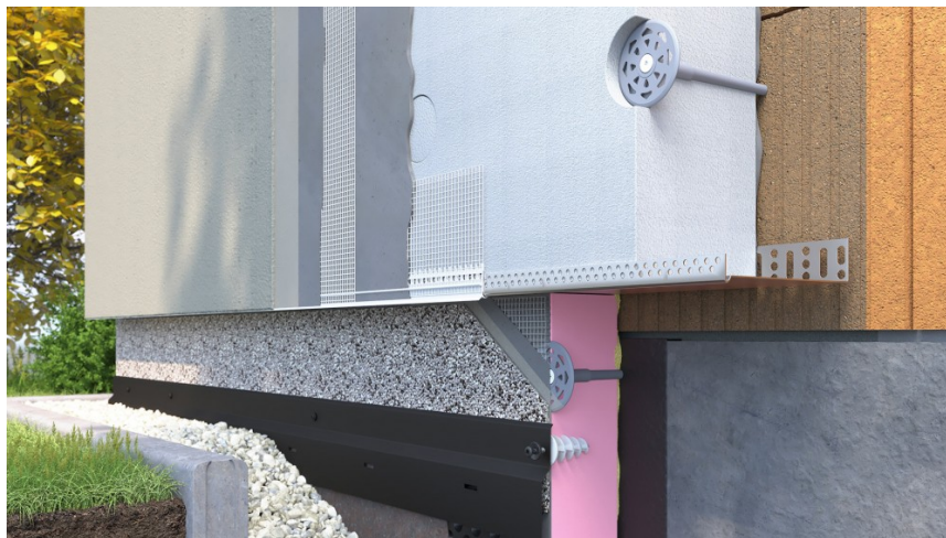
Obrázek 4: Kontaktní zateplovací systém s izolantem z EPS [19]
