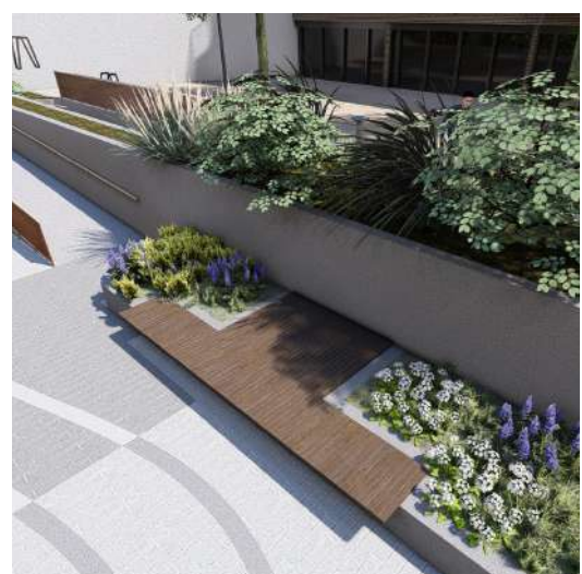
M02 DŘEVĚNÉ OBLOŽENÍ na míru vyrobené obložení navržených míst na sezení a ležení dubové dřevo, kovová konstrukce
