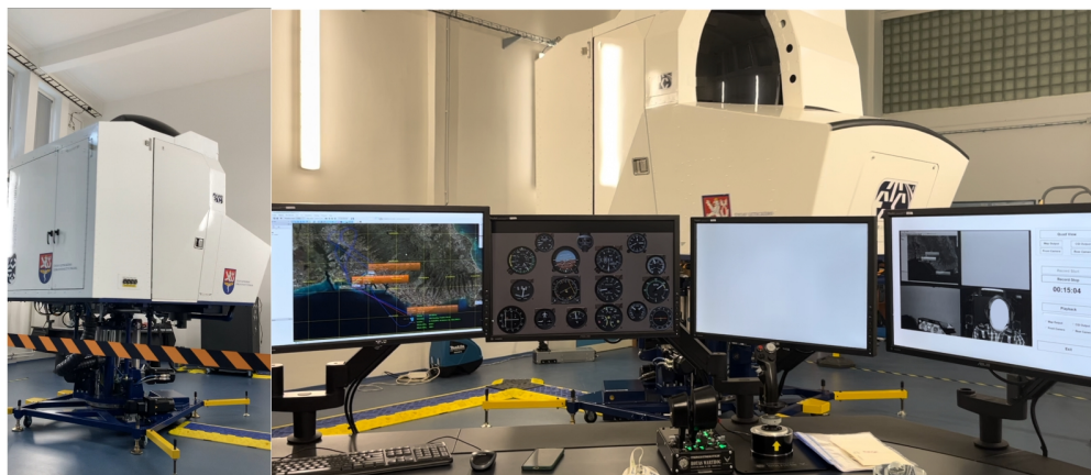
Obr. 2.2: Simulátor GYRO IPT II a jeho riadiace stanovisko.
