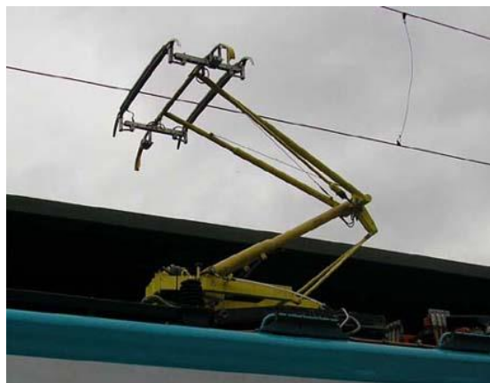
Obr. 3-1 Proudový sběrač (polopantograf) [10]
