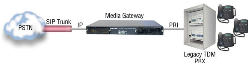
Obrázek 4.3: Znárodnění použití SIP trunk s TDM [5]
