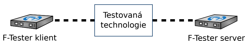
Obrázek 5.1: Zjednodušená topologie testování reálné sítě, vytvořeno z podkladů: [22]
