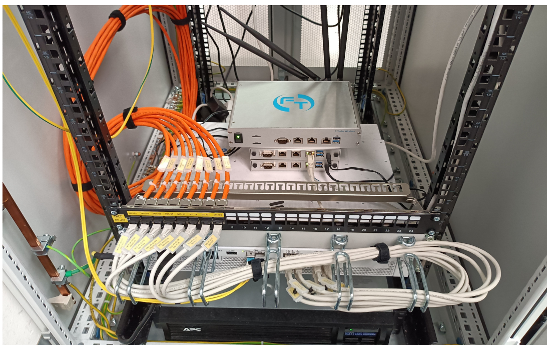
Obrázek 6.14: F-Tester 5G (fixní) položen na dvou F-Testerech (režim server) a IRU jednotce.
