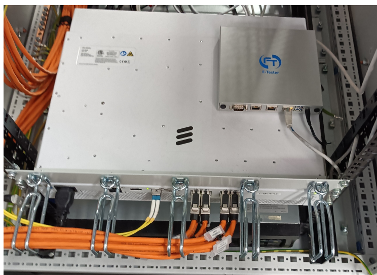
Obrázek 6.4: F-Tester server (protistrana pro testy) položený na IRU jednotce.
