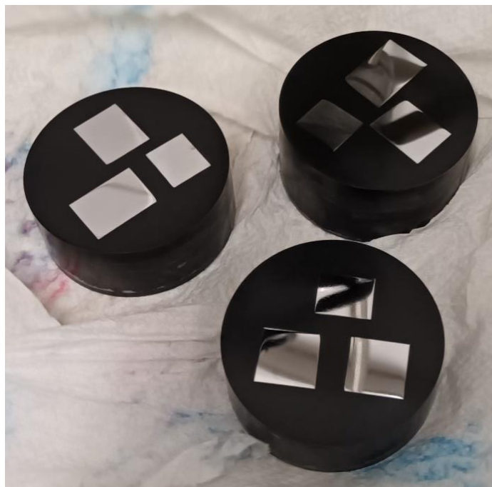
Obrázek 28 Leštěné a leptané vzorky připravené na metalografické vyhodnocení
