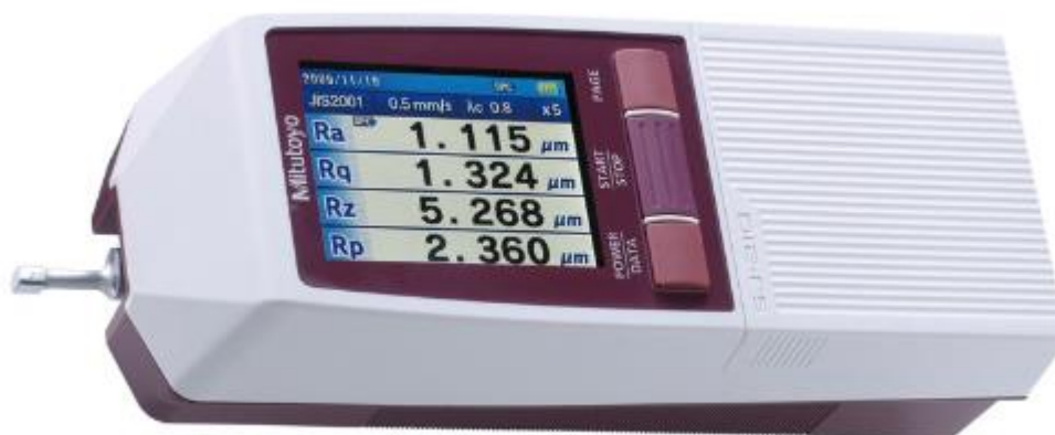
Obrázek 23 Drsnoměr mitutoyo SJ-210 [31]
