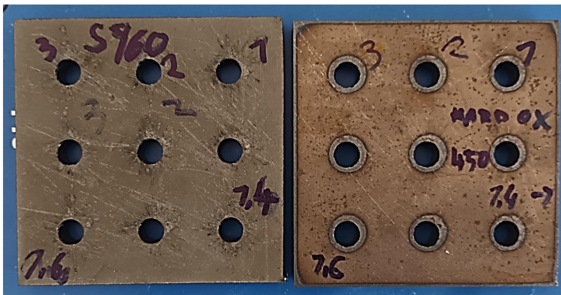
Obrázek 22 Vzorek Hardox a S960 pro vyhodnocování kvality řezu malých otvorů
