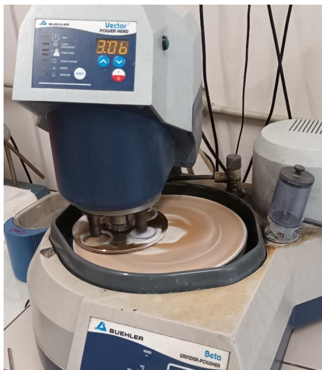
Obrázek 27 Proces leštění vzorků na disku master prep
