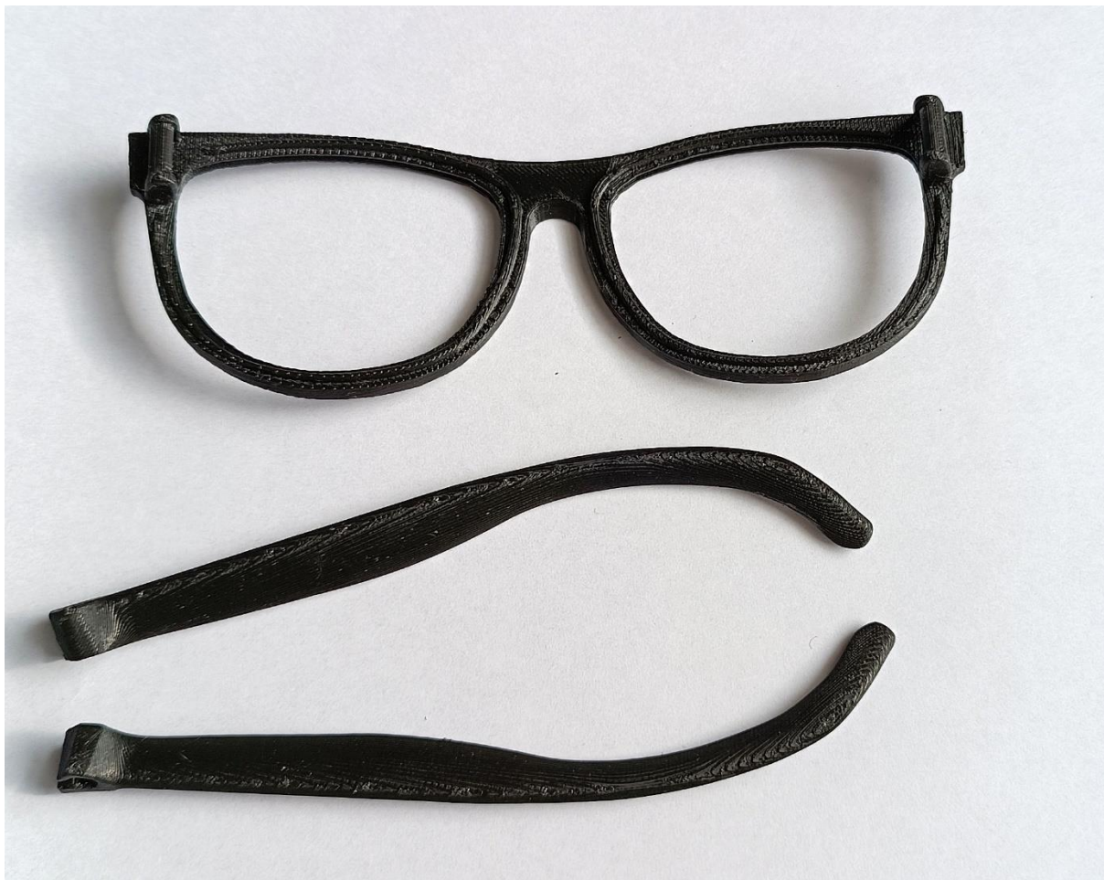
Obrázek 6.1.1 (b) Brýlová obruba po post-procesingu
