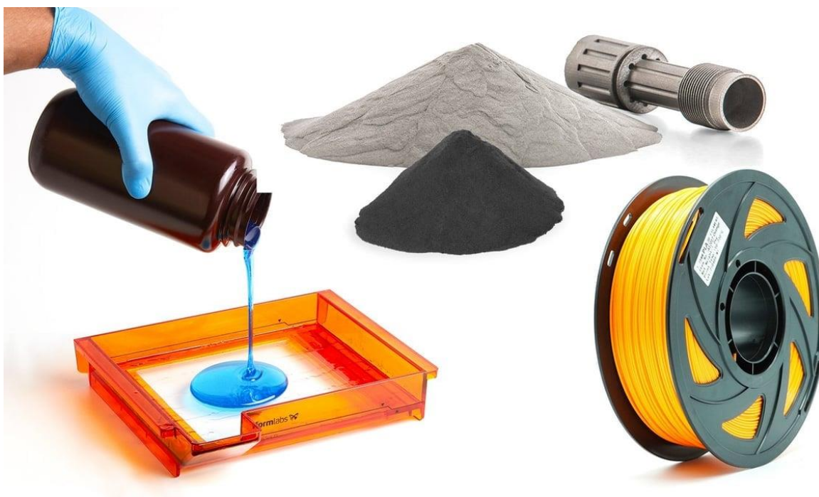
Obrázek 3 Materiály používané pro 3D tisk – fotopolymerní pryskyřice (vlevo), filament (vpravo), prášek (nahore) [Převzato z: 18]
