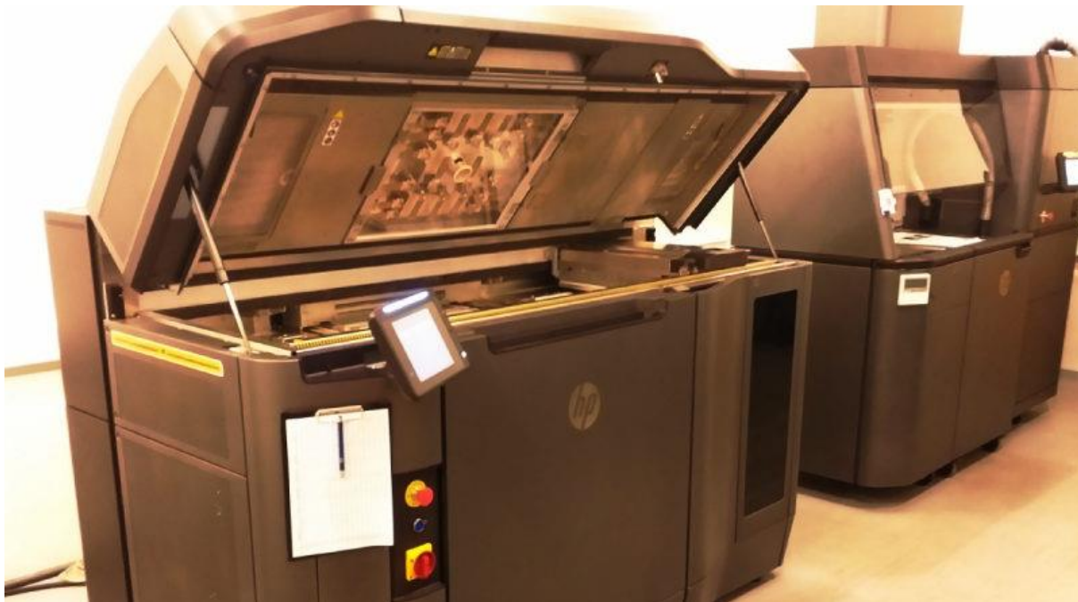
Obrázek 2.3 SLS tiskárna HP MJF 4200, využívající technologii Fusion Jet [Převzato z 17]
