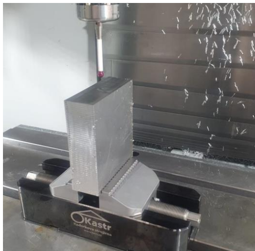
Obrázek 6.3 - Zaměření obrobku sondou
