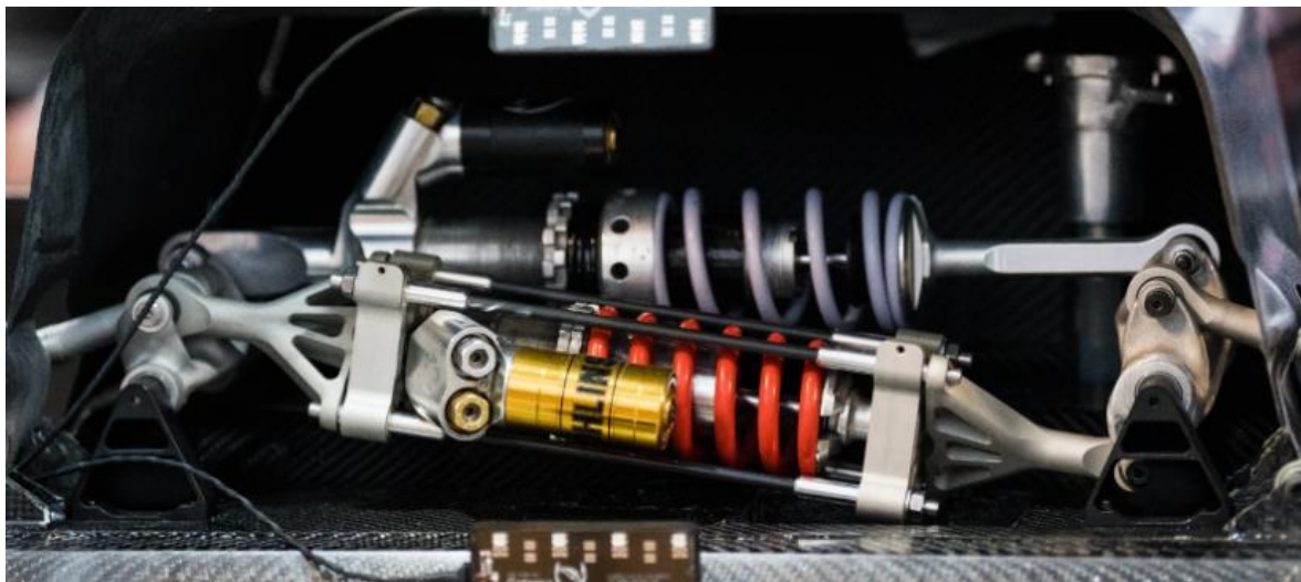
Obrázek 2.2 – Systém odděleného odpružení s odlívanými vahadly [13]
