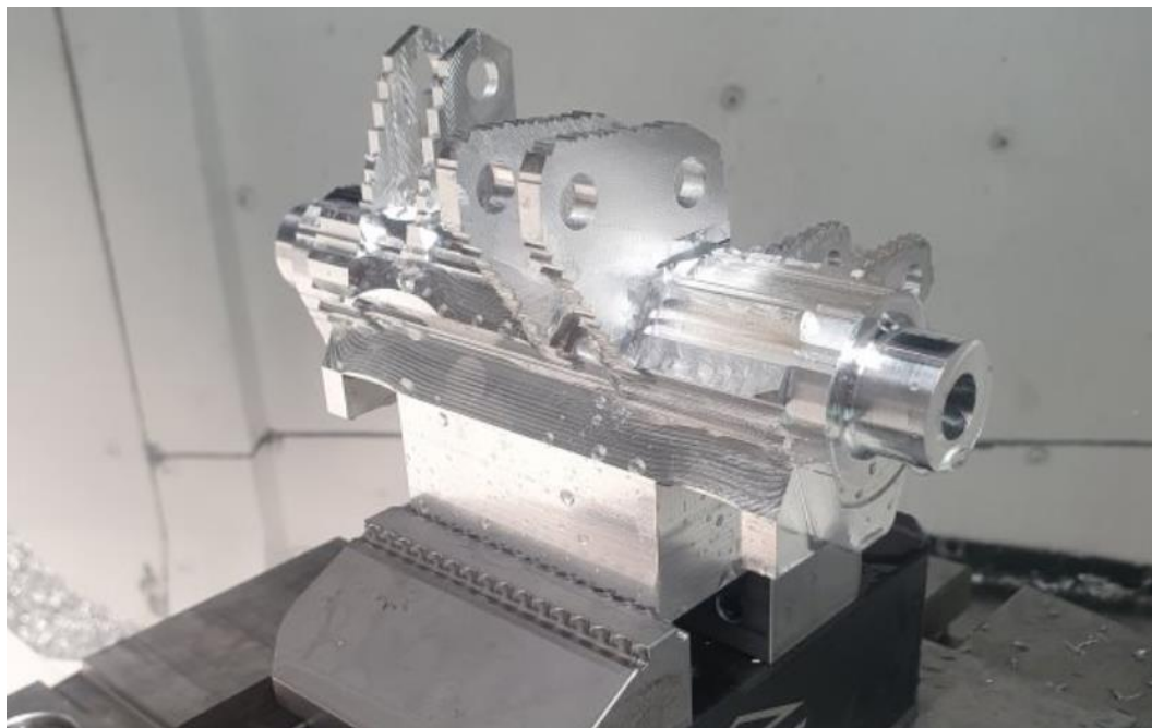
Obrázek 6.12 - Vyhrubované a vyvrtané vahadlo
