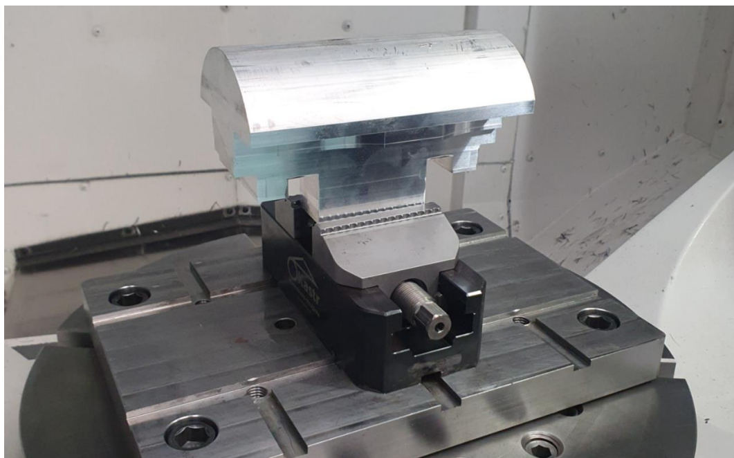
Obrázek 6.11 – Předhrubované vahadlo upnuté do stroje Okuma
