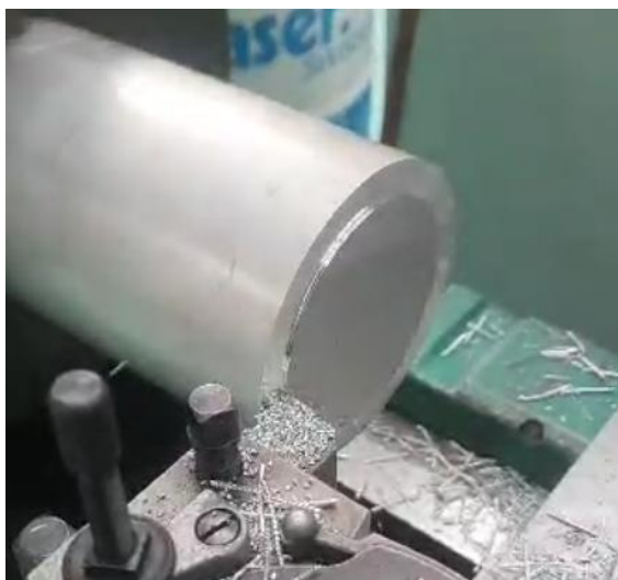
Obrázek 6.8 - Zarovnávaní čela na polotovarech vahadel
