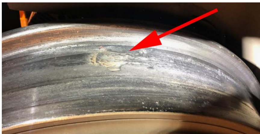
Obr. 14 – Ploché místo (Wheel flat) [15]
