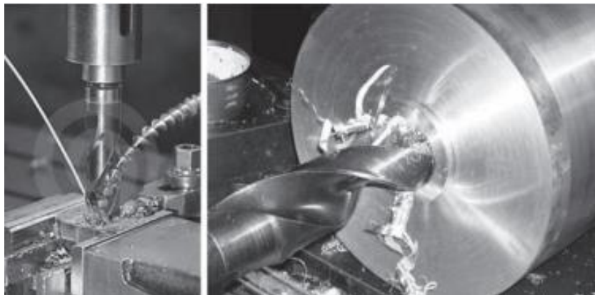
Obrázek 17 a) - Hlavní pohyb koná nástroj; b) – Hlavní pohyb koná obrobek [13]
