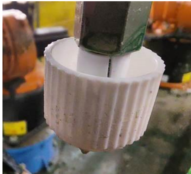
Obrázek 4 Mechanické selhání vylisku
