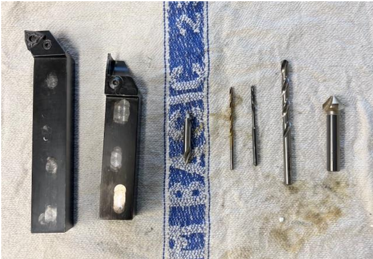
Obrázek 63 Nástroje použité pro 2 operaci zleva: Pravý čelní i podélný nůž; Upichovací nůž; Navrtávák; HSS vrták o průměru 2,9 mm; Výstružník 3,0 H7; HSS vrták o průměru 4,8 mm; Záhlubník trojhrbitý
