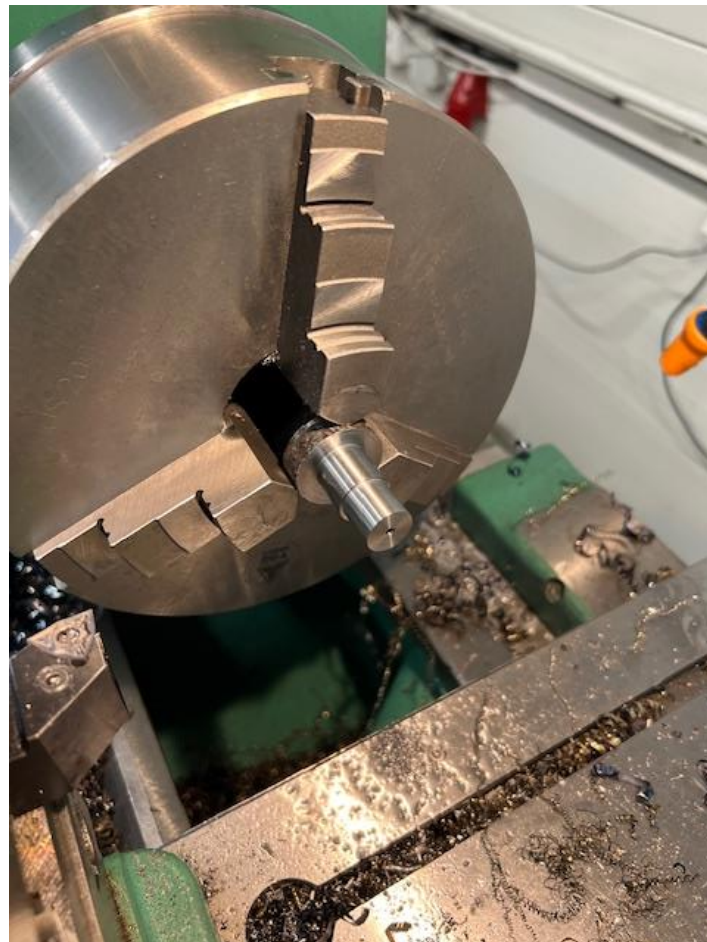
Obrázek 60 Výsledné jádro po obrobení – první upnutí
