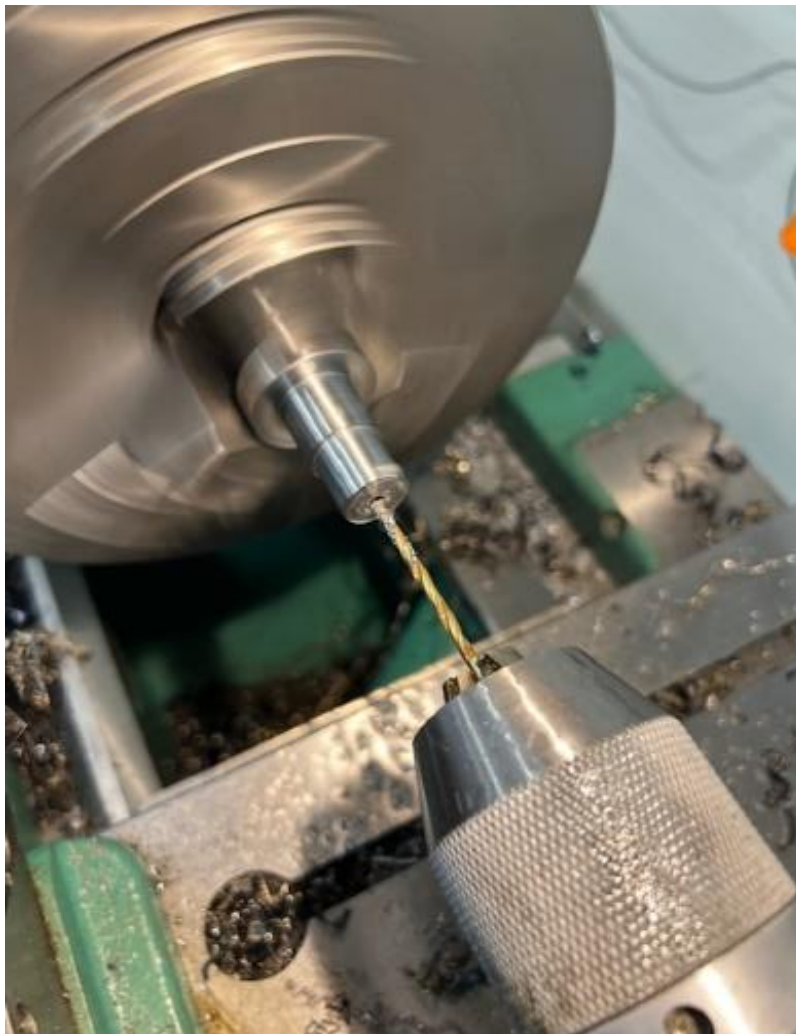
Obrázek 58 Vrták zanesený třískami
