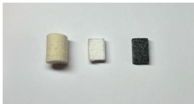
Obrázek 33 Přírodní plst' (vlevo); Přírodní s přím. syn. vlákny (uprostřed); Syntetická (vpravo)
