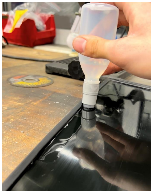
Obrázek 72 Lahvičkový aplikátor 16 mm při názorné aplikaci na vyřazené autosklo
