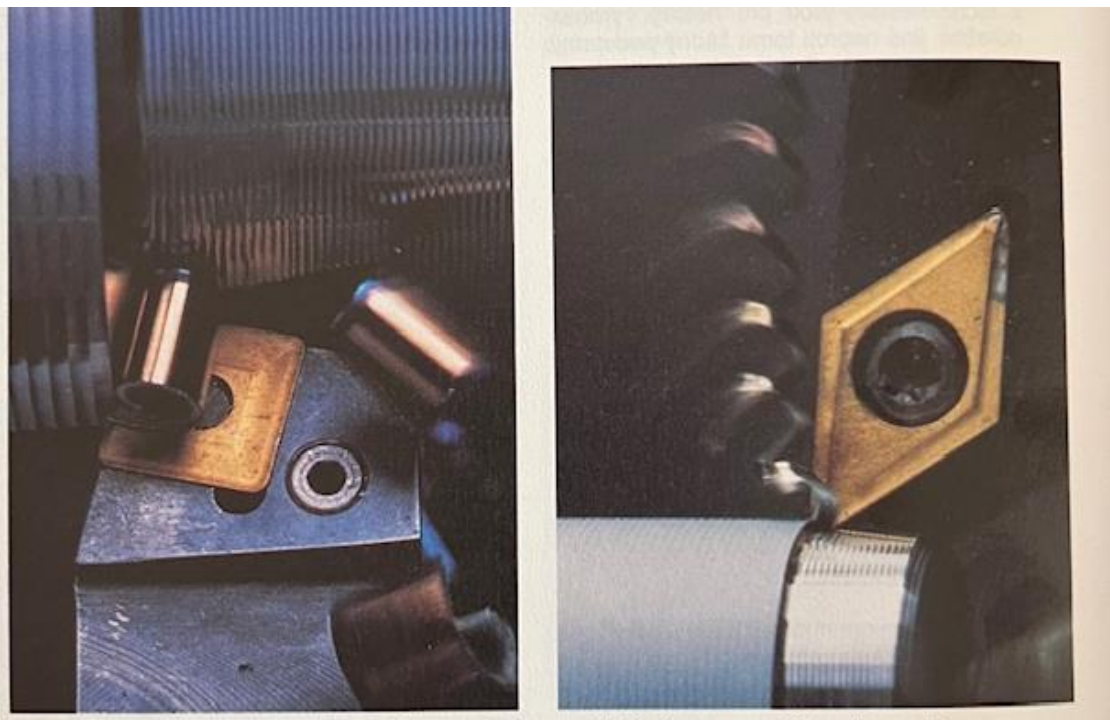
Obrázek 16 Porovnání nastavení ostří u hrubovacích a dokončovacích nožů [11]
