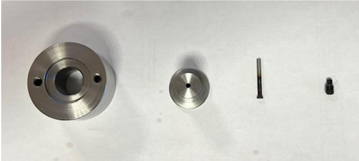
Obrázek 68 Výsledná sestava vložky zleva: Lůžko; Jádru; Koupená jehla; Koupený stavěcí šroub
