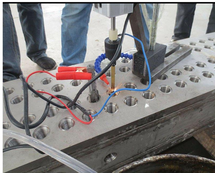
Obrázek 20 Vyjiskření zalomených nástrojů v dírách [13]
