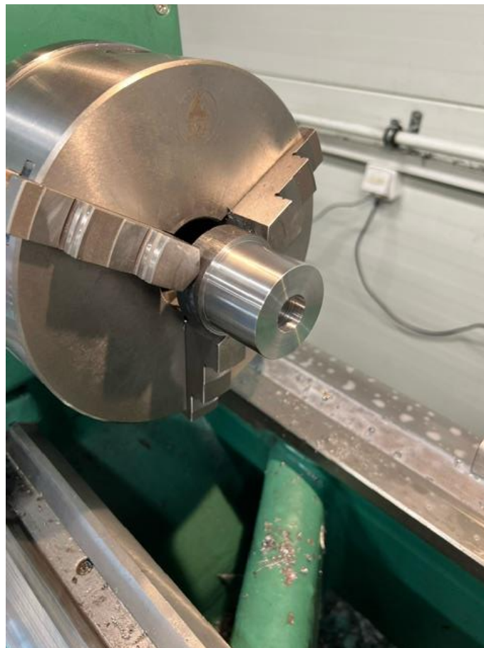
Obrázek 48 Výsledné lůžko po obrobení – druhé upnutí
