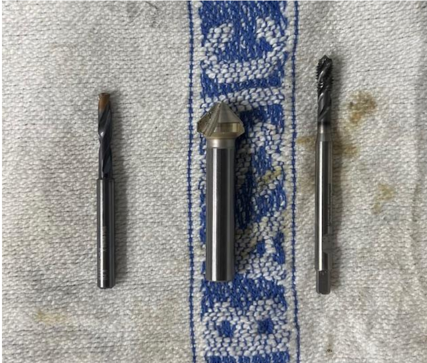
Obrázek 55 Nástroje použité pro 3 operaci z leva: Vrták TuC o průměru 4,8 mm; Záhlučník trojbrýťový; Strojní závitník M6 pro slepé díry
