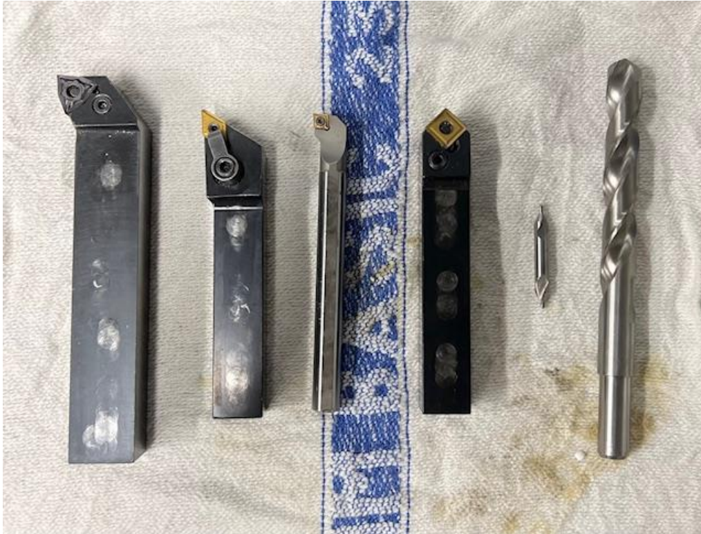
Obrázek 51 Nástroje použité pro 2 operaci z leva: Pravý čelní i podélný nůž; Dokončovací nůž; Vnitřní nůž; Nůž čtyřhranný; Navrtávák; HSS vrták o průměru 16 mm
