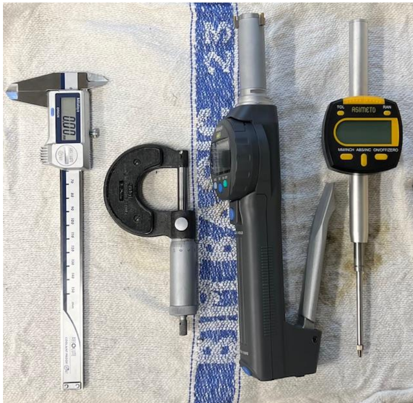
Obrázek 67 Měřidla použité pro výrobu zleva: Posuvné měřítko; Mikrometr; Tříbodový dutinoměr; Digitální úchylkoměr
