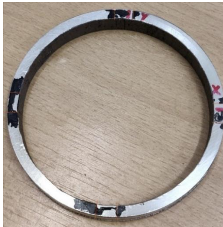
Obrázek 4.13: Ulomený kroužek s vyznačenými osami měření (viz protokol)
