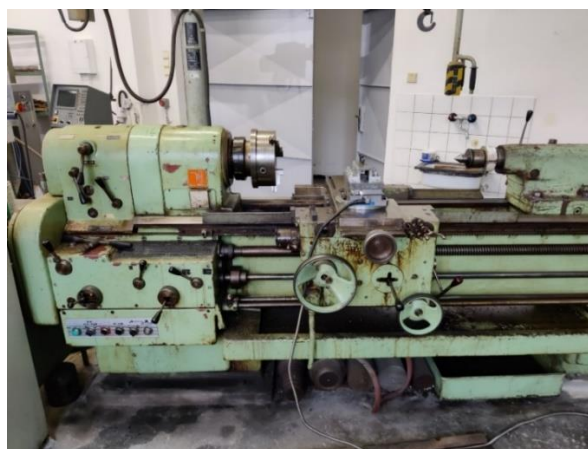
Obrázek 4.5: Soustruh SU 50/1500 osazený dynamometrem
