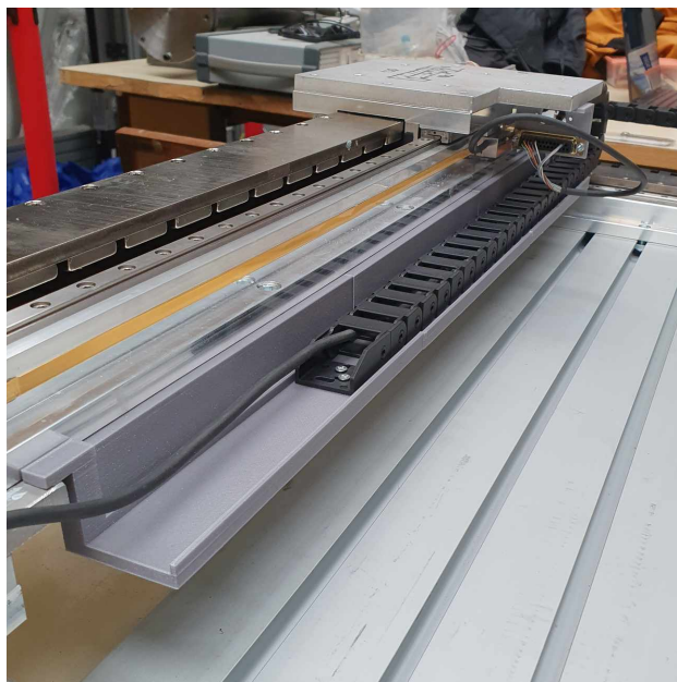
Obrázek 6.5: Detailní zobrazení vedení energetických řetězů
