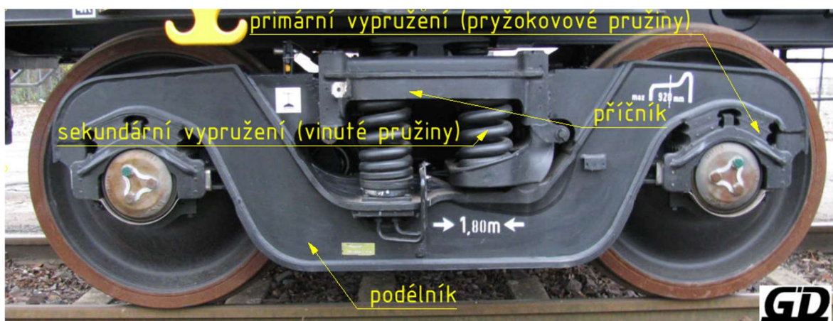
Obr. 14 - Podvozek RC25NT [41] (s doplněnými popisky)
