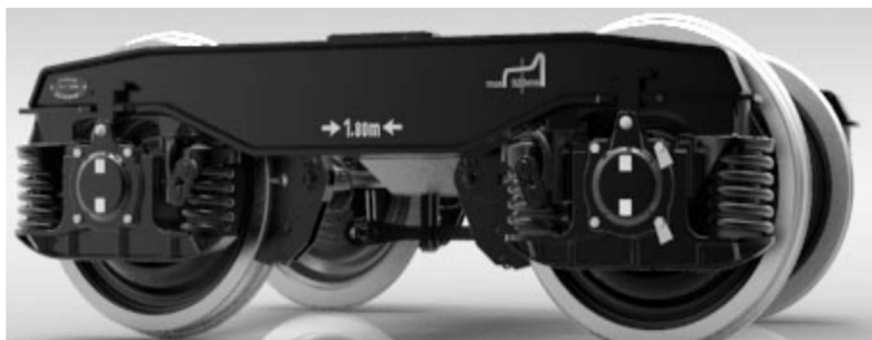
Obr. 60 - Podvozek Y25Lsd-K výrobce Greenbrier se skříňovými podélníky [8]
