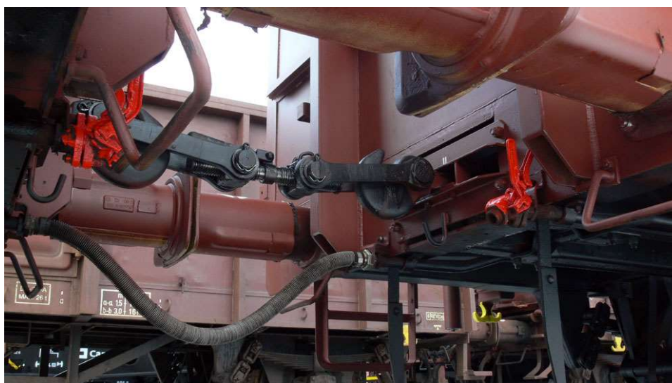
Obr. 3 - Spojení vozů dvouvozové jednotky na přepravu dřeva Laaps [56]
