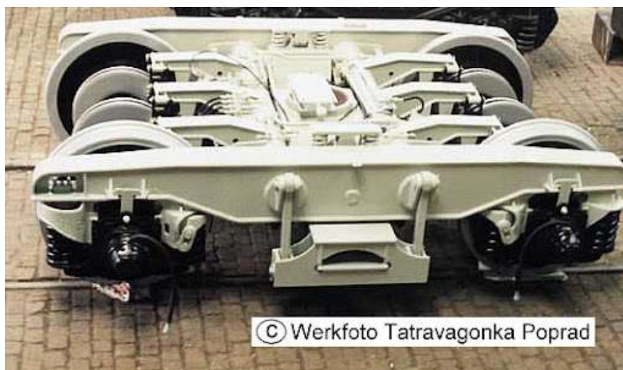
Obr. 42 - Podvozek Y 37 s podvěšeným příčníkem [24]
