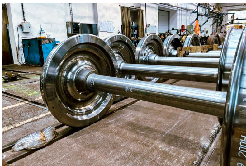
Obr. 16 - Dvojkolí pro vozy se špalíkovou brzdou [77]
