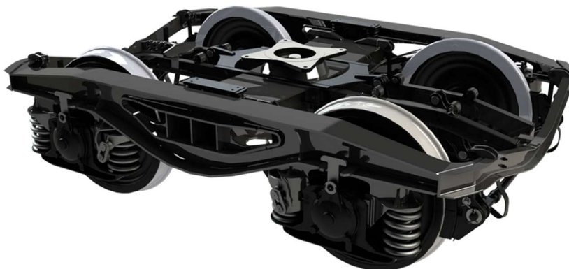
Obr. 59 - Podvozek Y25Ls(s)d1 výrobce Nymwag se standardními podélníky [7]
