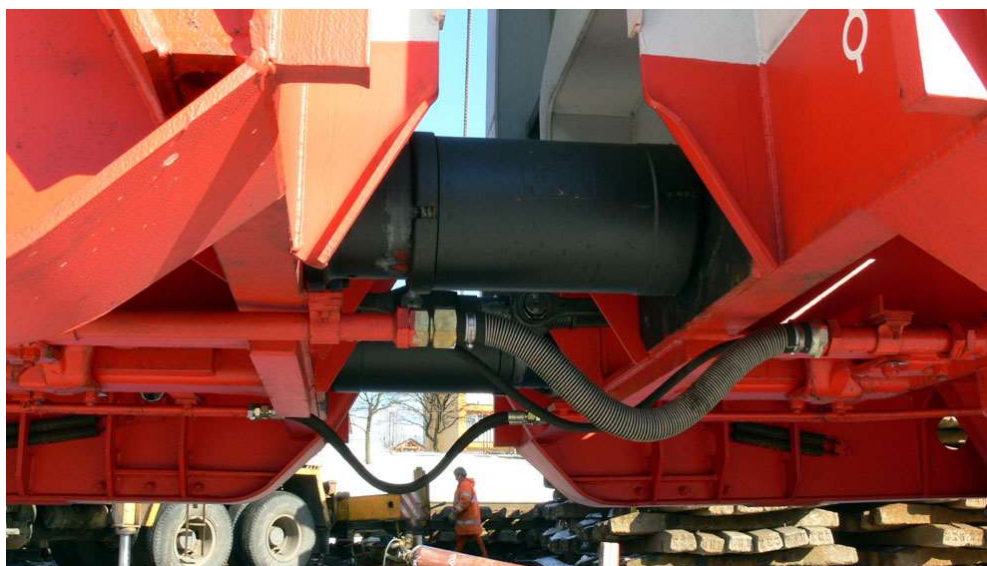
Obr. 4 - Spojení vozů dvouvozové jednotky na přepravu dřeva Laaprs [56]
