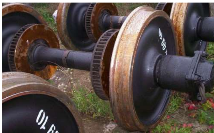
Obr. 15 - Dvojkolí pro vozy s kotoučovou brzdou [76]
