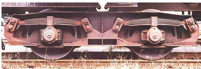
Obr. 52 - Podvozek BA 575 s krátkými hraníky [34]
