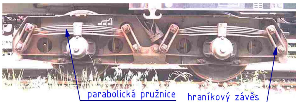
Obr. 26 – Podvozek BA 587 s hraníkovými závěsy [35] (s doplněnými popisky)
