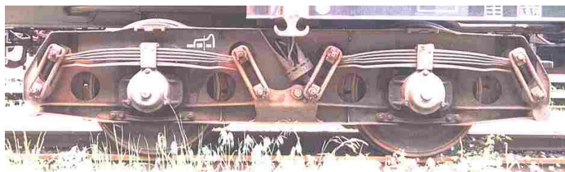
Obr. 53 - Podvozek BA 587 s dlouhými hraníky [35]
