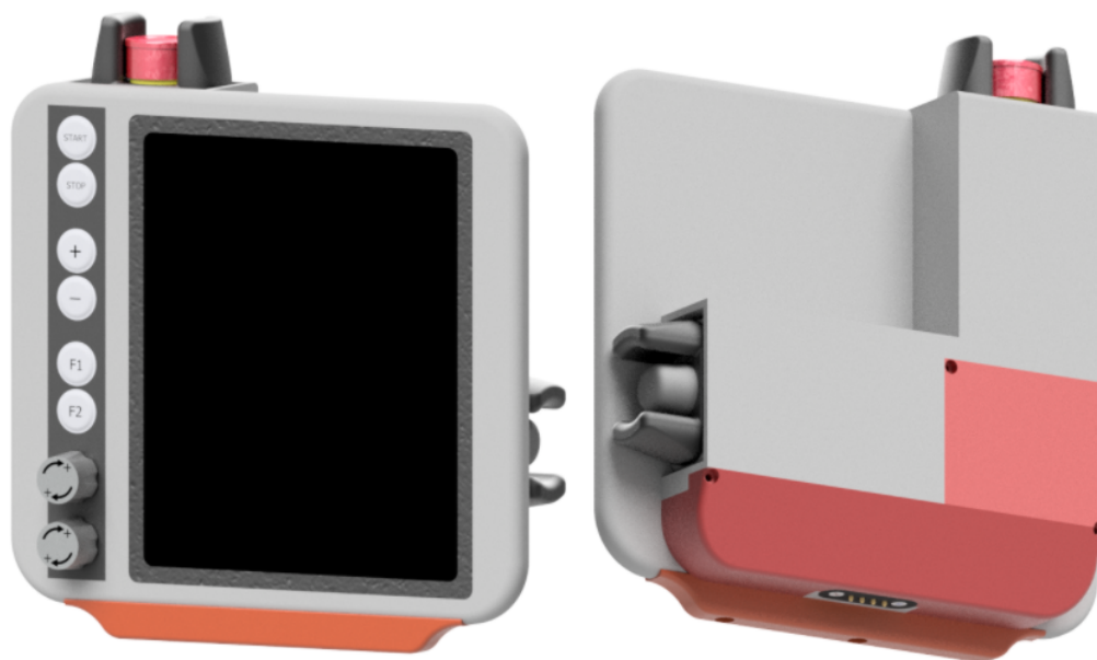
Obrázek 7.12: Zaoblení hran ovladače
