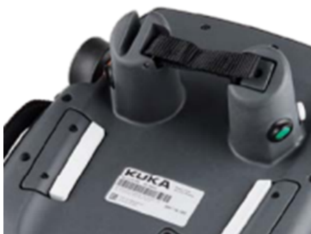
Obrázek 4.2: Spodní strana SmartPADu s ergonomickými výstupky pro držení jednou rukou a potvrzovacími spínači[15]
