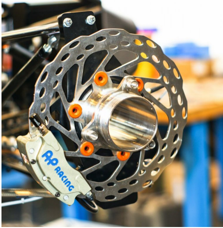
Obrázek 2.29: Použití plovoucích čepů, převzato z [25]
