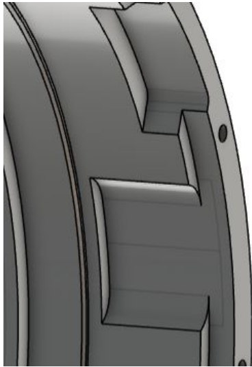
Obrázek 2.6: Odlehčovací kapsa mezi drážkami pro korunové kolo
