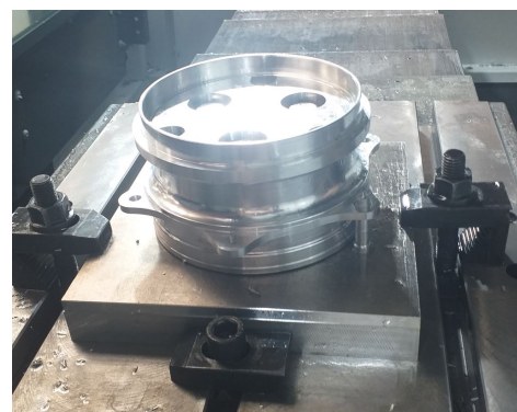
Obrázek 3.10: Upnutí obrobku pro operaci 60
