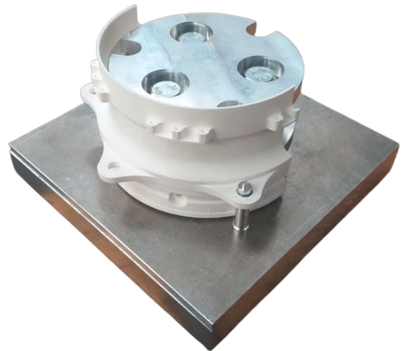
Obrázek 3.2: Vyrobený přípravek se zkušebním výtiskem náboje
